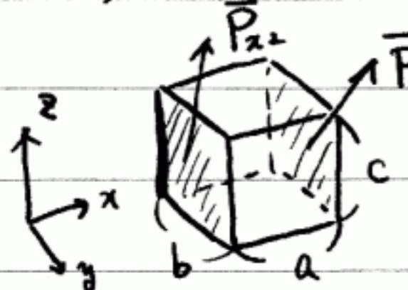
直方体、x方向面だけを取り出していく考え方。 $\vec{P}_{x1}$ ,  $\vec{P}_{xz}$  は面にはたらく力を示す圧力である。
