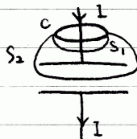
コンデンサーの充電中、Iの電流が流れているとする。
