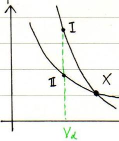
2本の断熱曲線が状態 X で交わる。たとえば、2本の断熱曲線上で体積  $V_1$  である点をそれぞれ I, II とする。(図) 今、断熱曲線上で I  $\rightarrow$  X  $\rightarrow$  II と動かす操作を考える。条件より、 $T_I > T_{II}$  であり、 $V_I = V_{II}$  である。
