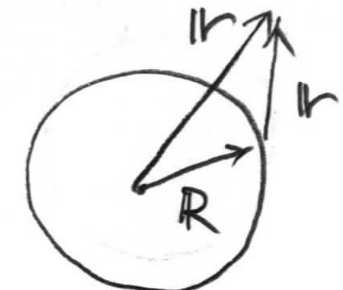
$$m\mathbf{a}' = \mathbf{F} + m\mathbf{g}_0 - 2m\omega \times \mathbf{v}' - m\omega \times (\omega \times (\mathbf{R} + \mathbf{r}')) \quad \text{④}$$
